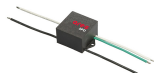
Codice: 237 SPD: (Surge Protection Device) (dispositivo di protezione contro le sovratensioni) 275Vac Massima corrente di scarica 10KA (8/20 \mu s) Massima corrente di esercizio 5A Idoneo per connessioni in cascata sulla linea - IP66
